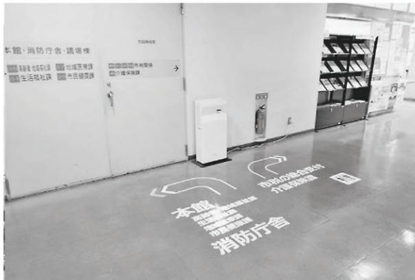
加古川市に導入されている「てらすガイド」は、高い視認性の光のアニメーションを用いたサインを床面に表示し、直感的で分かりやすい案内や注意喚起を行うことで、多様な施設利用者の円滑な移動を支援するシステム。コンセント一つで容易に設置できるほか、簡単操作で表示コンテンツの入れ替えが可能。案内ポスター
