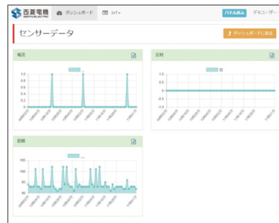
◀（左）「工作機械作業時間見える化キット」管理画面イメージ ▶（右）同上 距離センサー・電流センサー・反射センサー
