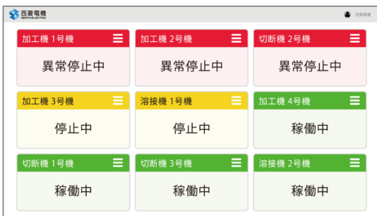
◀（左）「信号灯状態検知ユニット」管理画面イメージ ▶（右）「信号灯状態検知ユニット」照度センサー取付時イメージ
